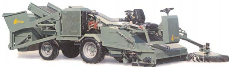
Figura 12.8 - Colhedor misto automotriz com encordoamento mecânico e recolha mecânica
