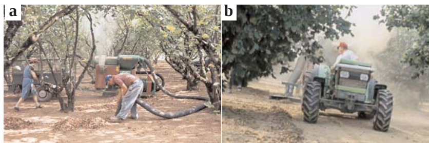
Figura 12.4 - Colhedores pneumáticos rebocados: com apanha manual (a) e com apanha mecânica (b)
