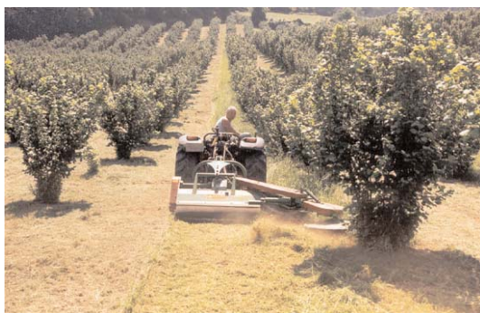
Figura 9.2 - Controlo mecânico com triturador e gadanheira rotativa para corte das infestantes na linha
