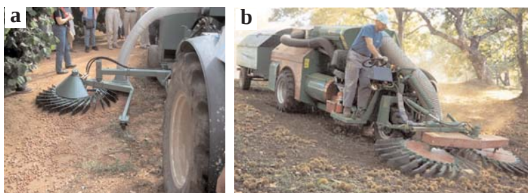
Figura 12.7 - Colhedor misto rebocado (a) e colhedor misto auto-motriz (b), com encordoamento mecânico e recolha pneumática
