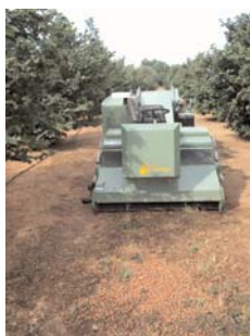
Figura 12.1 - Colhedor mecânico automotriz com as avelãs previamente encordoada e pormenor do pickup
