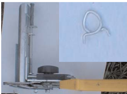
Figura 5.5 - Alicate de anilhamento e anel
