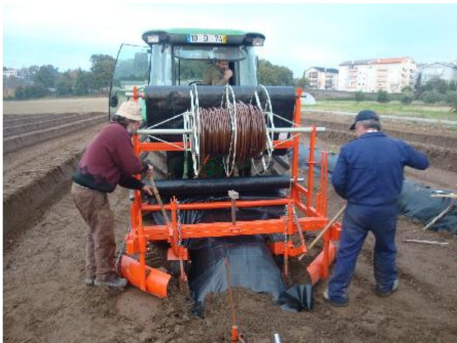
Figura 2 – Equipamento utilizado para armar o terreno em camalhões
