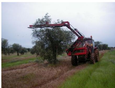
Figura 2 - Corte horizontal da copa da árvore com máquina de podar de discos, em 2002.
