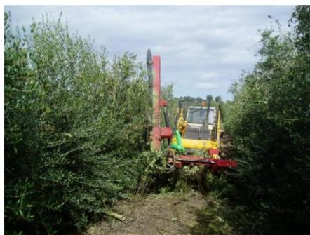
Figura 4 - Máquina de podar de discos a efectuar corte vertical.
