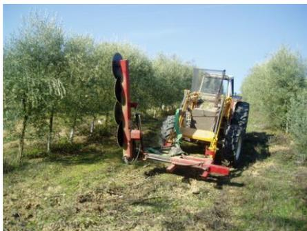
Figura 1 - Aspecto da barra de corte da máquina de podar de discos.
