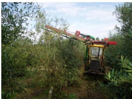
Figura 3 - Máquina de podar de discos a efectuar corte horizontal.
