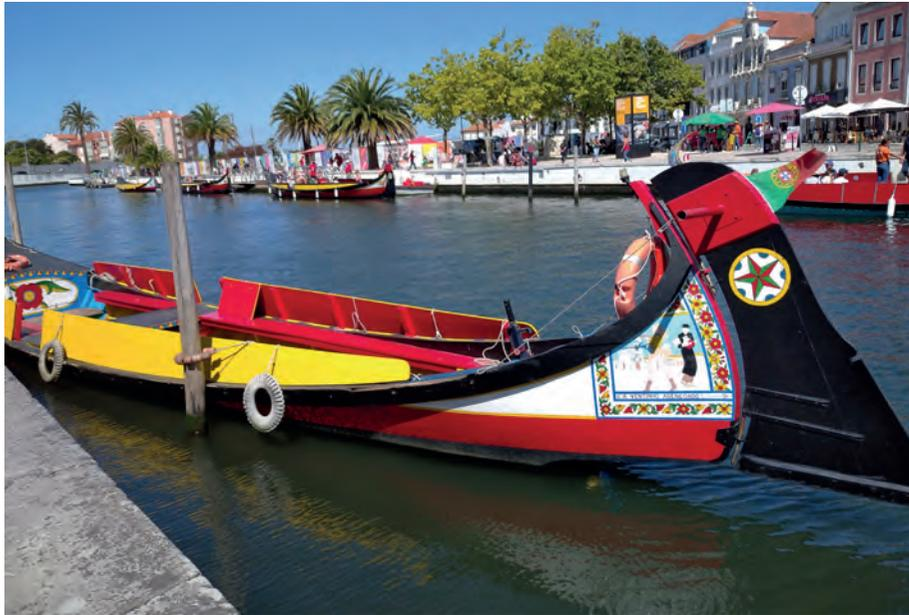
O Barco Moliceiro é uma embarcação tradicional de madeira, originária da região de Aveiro, que foi inicialmente criada e utilizada para a apanha do molicho na ria de Aveiro. A tarefa de apanha do molicho e as condições de navegação na ria originaram a necessidade de criação de uma embarcação com o fundo chato, mais adaptada a águas pouco profundas, e costados baixos.
