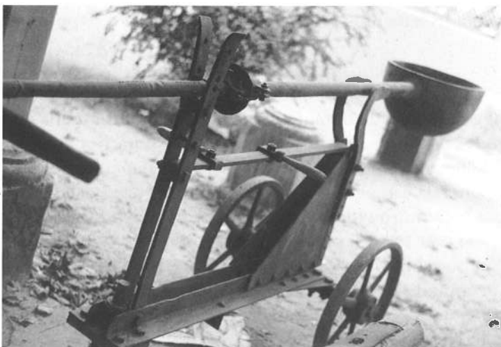
Fig. 96 - Colher para colha e vazamento. Patente na exposição "A indústria do vidro na perspectiva da arqueologia industrial", FEIS, 1989.
