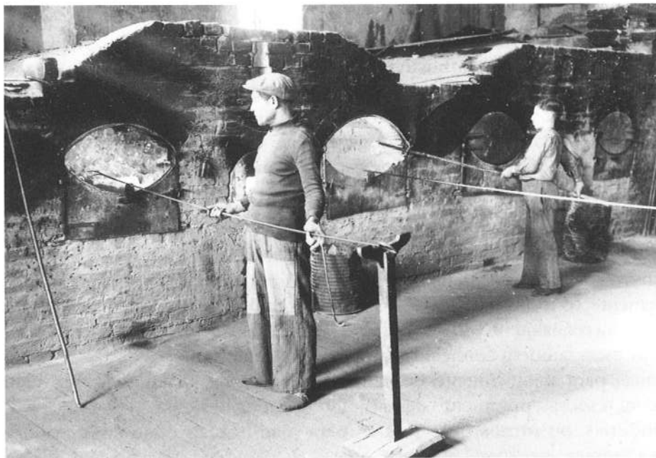
Fig. 62 - Forno conhecido por arca fixa de recozimento, vendo-se o “atiçador” usando uma comprida forquilha.
