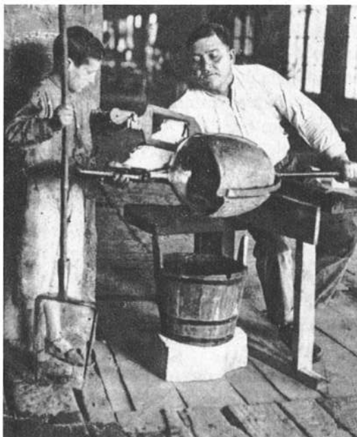
Fig. 101 - fabrico manual de garrafões. Fotografia de Víctor Gallo.
