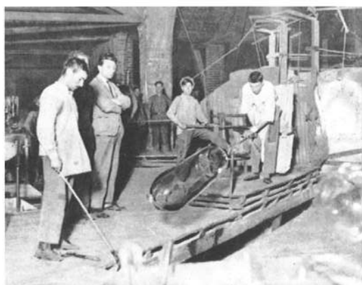
Fig. 90 - Fabrico manual de vidraça: fotografia de Víctor Gallo.
