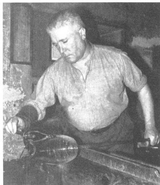
Fig. 78 - Cristalaria, fase do fabrico manual: colocação da asa num jarro.
