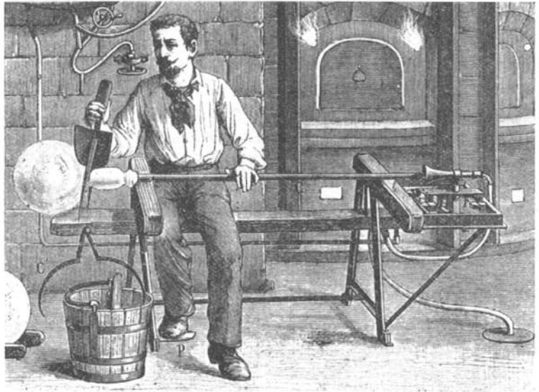
Fig. 69 - Utilização de ar comprimido.
