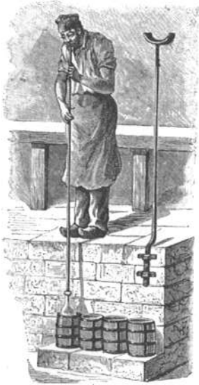
Fig. 68 - Garrafeiro a soprar para molde (que não abre).
