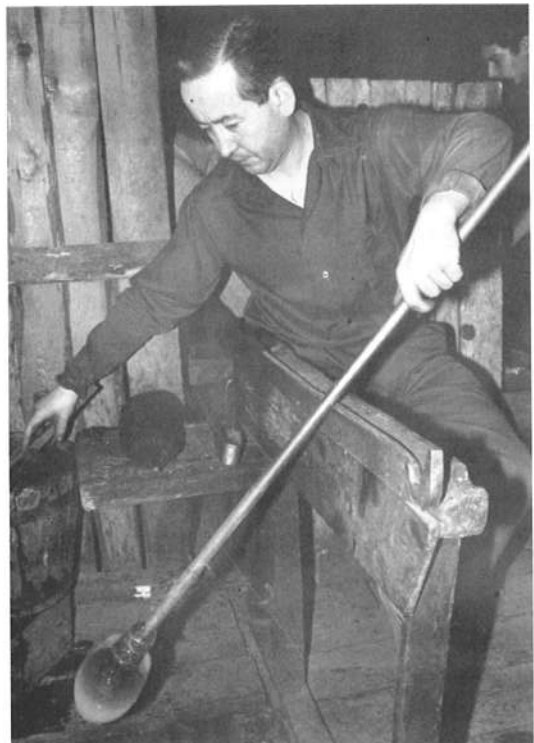
Fig. 67 - preparação da bolha de vidro
