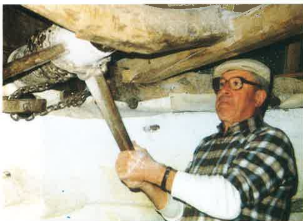
96 O moleiro dando ao sarilho. Além deste, podem ver-se igualmente a ponte do sarilho, os pontaletes e, cravados na parede, os andorinbos. Moinho da Serra da Costa, freguesia de Vilar.
