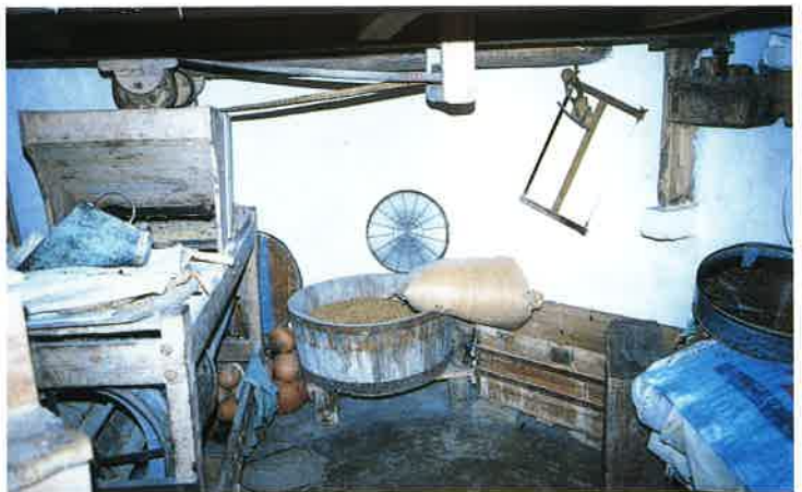
107 O «inferno» do moinbo da Serra da Costa. Além do peneiro mecânico e do grão para moer ou de alguma saca de farinha, aqui guarda o moleiro os crivos e as bandejas de limpar o grão, os búzios e as alfaias indispensáveis ao seu ofício.
