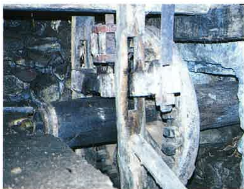
109 O «inferno» da azenha do Vilar. Além do mastro e da entrosga podem observar-se o carroto, o urreiro e o aliviador.
