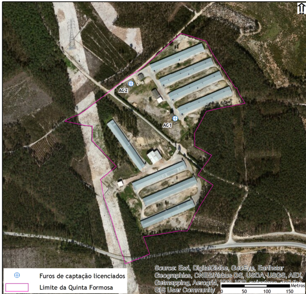
Figura 2 - Locais de amostragem do programa de monitorização para a Qualidade das Águas Subterrâneas.
