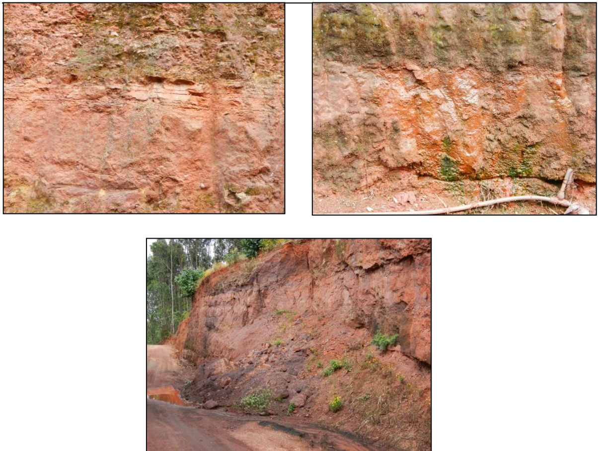
Figura 15– Em cima, à esquerda: rocha argilosa vermelha da formação das Margas de Dagorda, com depósito de vertente sobrejacente; em cima, à direita: Ocorrência de água proveniente da rocha argilosa; em baixo: pequena derrocada no talude situado atrás dos pavilhões.
