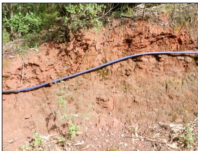
Figura 20– Perfil do solo no local do projeto. Nota-se o desenvolvimento fraco do horizonte A (orgânico).
