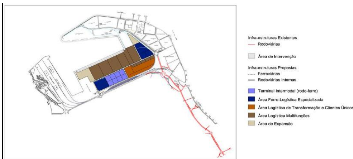
Figura 108: Layout Indicativo da Plataforma Logística de Aveiro (Pólo Portuário) Fonte: Ministério das Obras Públicas, Transportes e Comunicações (2006)
